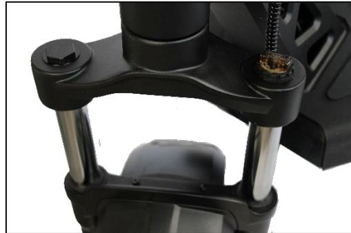
Die Federgabel lässt sich mit einer Einstellschraube justieren, welche sich auf der rechten Seite unten an der Federgabel befindet. So wird die Federung (gegen den Uhrzeigersinn) weicher oder (im Uhrzeigersinn) härter.
