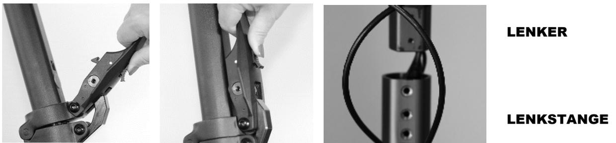
3. Nimm nun die 6 Schwarzen Schrauben mit der blauen Markierung (Schraubenkleber für besseren Halt), sowie den dazu passenden Inbusschlüssel **A**. Setze jeweils eine gegenüberliegende Schraube ein und schraube diese leicht an. Abwechselnd vorne und hinten die Schrauben festziehen.
