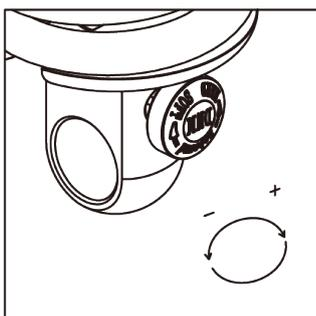
Linksherum drehen um den Stoßdämpfer weicher zu machen und rechtsherum drehen um den Stoßdämpfer härter zu machen.
