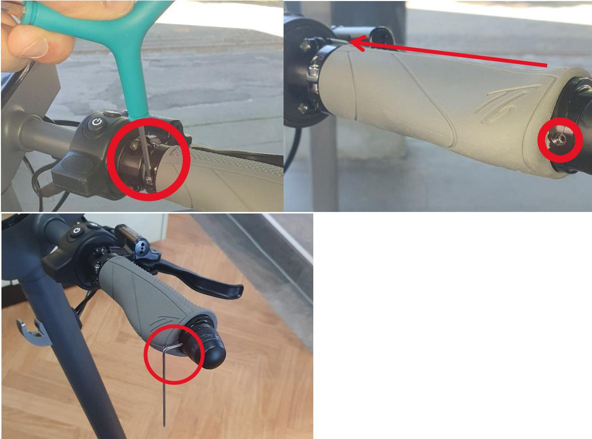
5. Ziehe nun den Blinker vorsichtig heraus, trenne diesen von der Steckbindung und schließe den Kellermann Blinker an. Den angeschlossenen Kellermann Blinker mit den Steckbindung vorsichtig hineinschieben.
