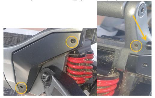
2. Nun Steckst du den Kellermann-Blinker mit dem Kabel durch den dazugehörigen Zugang und verbindest es mit der Steckbindung, die sich hinter der Blende befindet.
